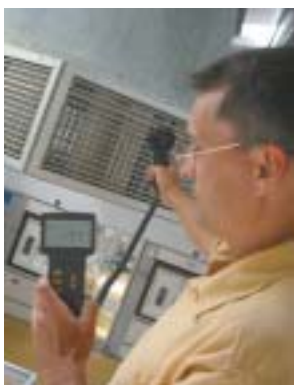
Soufflage à 17.4°C, et 78% d'hygrométrie à une vitesse de 5 m/s
